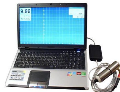
Прибор по измерению КГР – «Индикатор психоэмоциональных реакций» (ИПЭР-1К)
